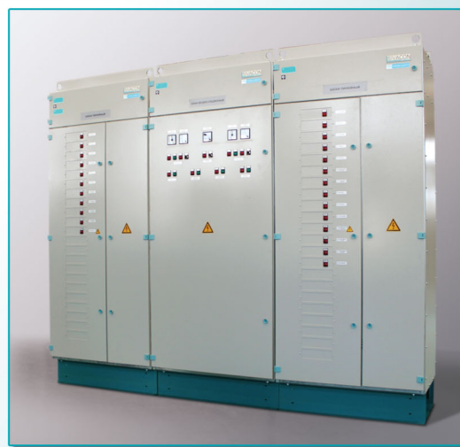
Функциональные блоки собственных нужд постоянного тока Одностороннее обслуживание, внутренняя установка. Номинальный постоянный ток главных цепей до 160 А, номинальное напряжение постоянного тока до 220 В.
