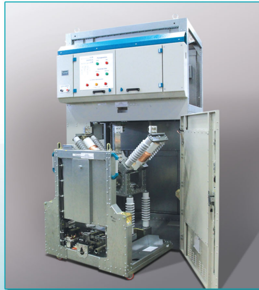
Ячейка переключателя пункта группировки станции стыкования контактной сети 3,3 кВ постоянного тока и 27,5 кВ переменного тока 1С-ПВ-3,3/27,5 Одностороннего обслуживания, внутренней установки. Номинальный ток главной цепи постоянного тока – 1400 А, сети переменного тока – 1000 А. Подключение главных цепей – шинное.
