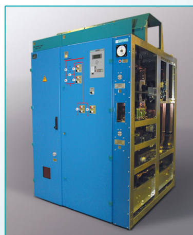
Комплектное распределительное устройство постоянного тока на напряжение 825 В серии "1С-825" Одностороннее обслуживание, воздушная изоляция, использование стационарно установленных выключателей серии ВАБ-206 с током главных цепей до 8000 А.
