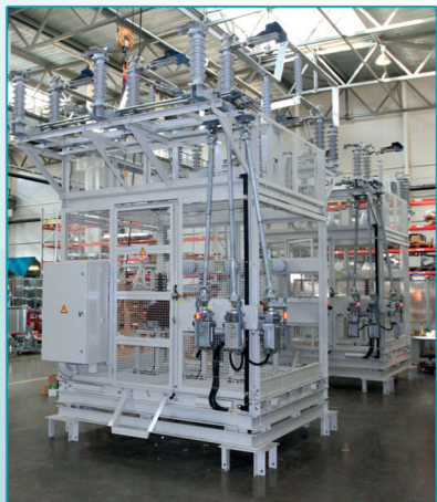
Блоки открытых распределительных устройств переменного тока на напряжение до 35 кВ
