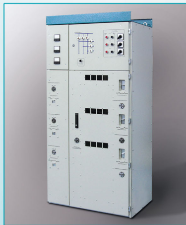
Комплектное распределительное устройство постоянного тока отрицательной шины РУОШ-600 В Одностороннее обслуживание, внутренняя установка, воздушная изоляция, с током главных цепей до 4000 А.
