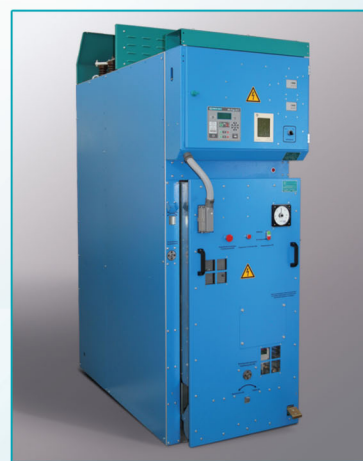
Комплектное распределительное устройство постоянного тока на напряжение 825 В серии "КВ-825" Одностороннее обслуживание (уменьшенный габарит), внутренняя установка, воздушная изоляция, использование выкатных выключателей серии ВАБ-206 с током главных цепей до 8000 А.
